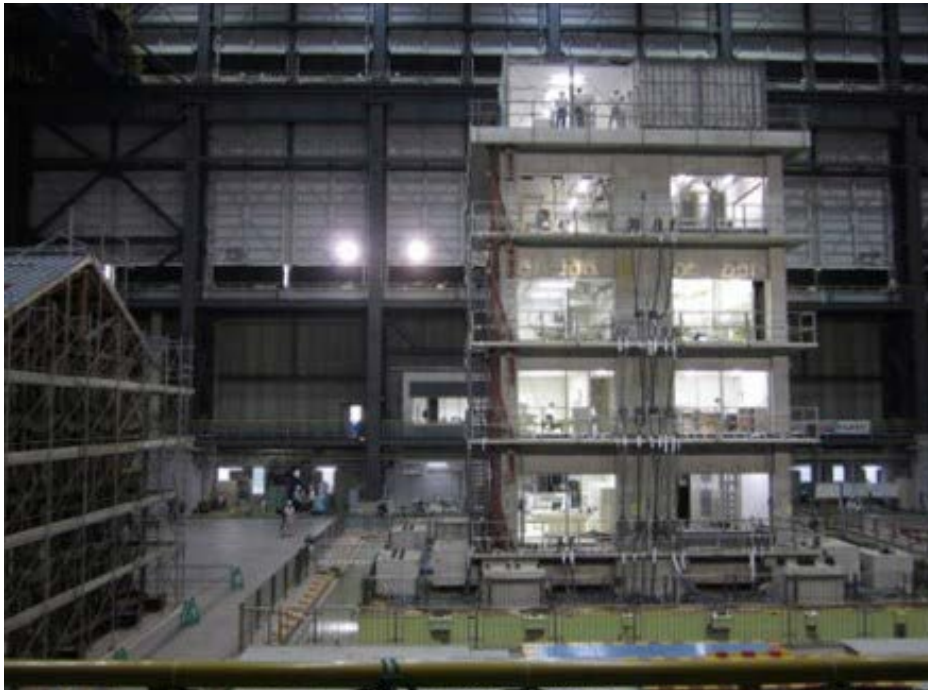
FIGURE 18. Gross-Simulation eines Gebäudes auf einem Erdbebensimulator in Japan
