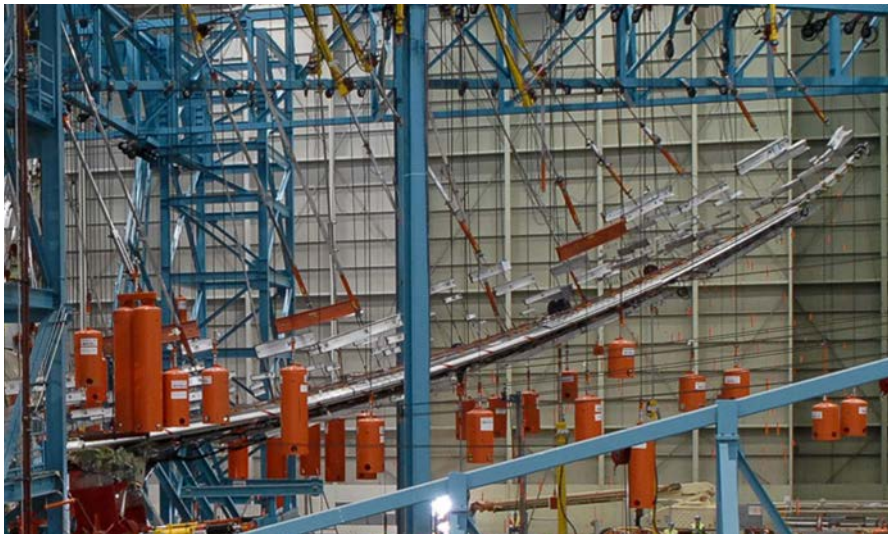
FIGURE 14. Belastungsversuch an einem Flügel des Typs Boeing 787 Dreamliner
